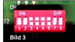
**Achtung:** Nach Änderung der Schiebeschalterstellung muss das Gerät kpl. stromlos geschaltet werden. Der Batterie OFF-Taster an der Geräterückseite (siehe Kapitel „Installationsschritte und Funktionsprüfung“) muss dafür bei abgezogenem Netzstecker betätigt werden. Danach wird das System in Funktion gesetzt.
