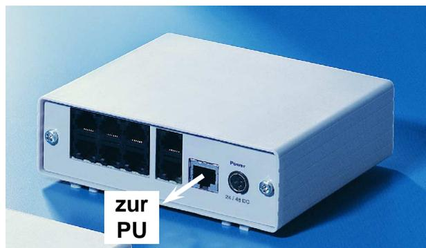
Das FCS kann optional mittels separatem Cat.5-Kabel direkt an einen freien Port der CMC-TC-Processing Unit angeschlossen werden. Für das Betreiben des FCS am CMC-TC ist die SW-Version 1.20 oder höher erforderlich. SW-Update und Anleitung zum Update finden Sie auf unserer Homepage.
