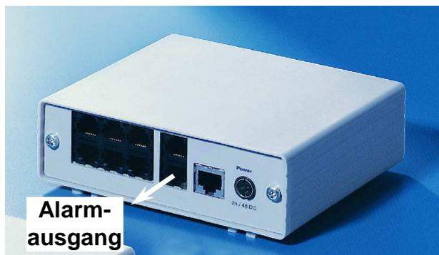
Die Alarmrelaiskontakte werden über die RJ 12-Buchse herausgeführt. Die technische Spezifikation des Alarmrelais finden Sie im **Anhang B1 Technische Daten**, die Sie aus technischen und sicherheitsrelevanten Gründen nicht überschreiten dürfen. Das Relais zieht im Normalbetrieb an, es schaltet durch Abfallen im Alarmfall oder bei Spannungsverlust der Einheit. Im Alarmfall lässt es sich durch die Taste C nicht abschalten.
