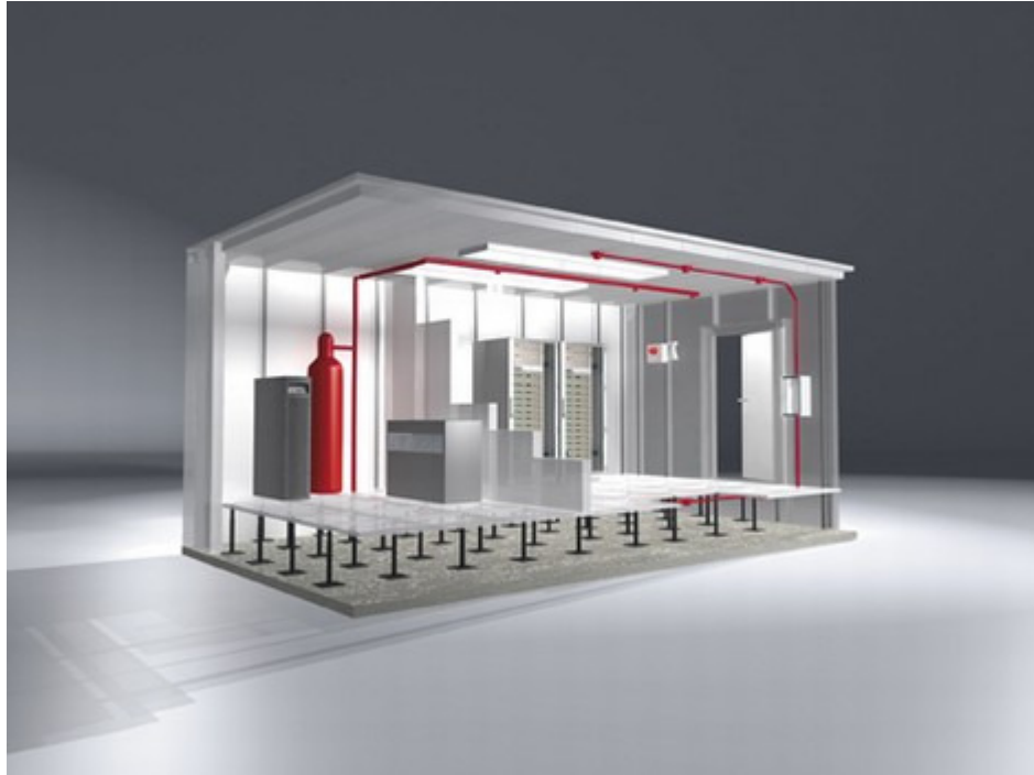
Abbildung 9: IT- Sicherheitsraum mit Löschanlage
