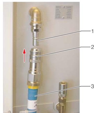
**Abb. 8: Schnellkupplung am Kühlwasseranschluss**
