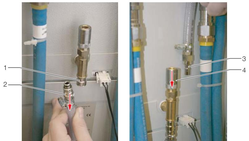
**Abb. 3: Schnellkupplung am Kondensatablauf**
