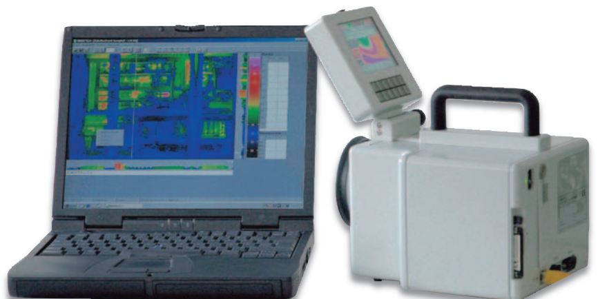
Lokalisierung von Hot-Spots per Thermographie.
