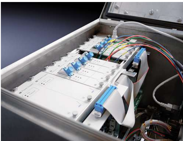
Das Kommunikationssystem von DEV ist modular aufgebaut und besteht aus einzelnen Steckkarten für jeweils einen Kanal, die in einen entsprechenden Baugruppenträger gesteckt werden.
